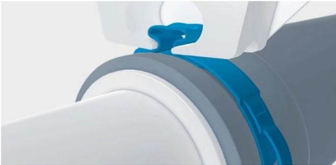
Pour un montage correct, positionner les mâchoires de serrage à la base de l'oreille du collier. Fermer les mâchoires de serrage pour comprimer l'oreille du collier. Ceci réduit le diamètre du collier de serrage à oreille ToothLock®. L'outil peut être retiré une fois les mâchoires de serrage ouvertes après la fermeture de l'oreille.
