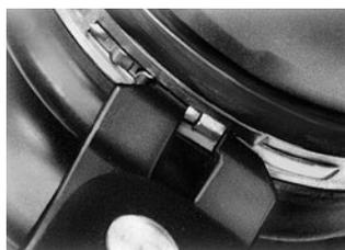
Con la utilización de la tenaza neumática de control electrónico Oetiker ELK se garantiza un control total del proceso y la posibilidad de tener una trazabilidad al 100%.
