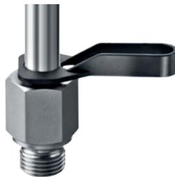
Zum Auskuppeln Demontagewerkzeug/Hülse bis zum Anschlag in den Quick Connector eindrücken, in dieser Position halten und Rohrende/Stecknippel herausziehen.
