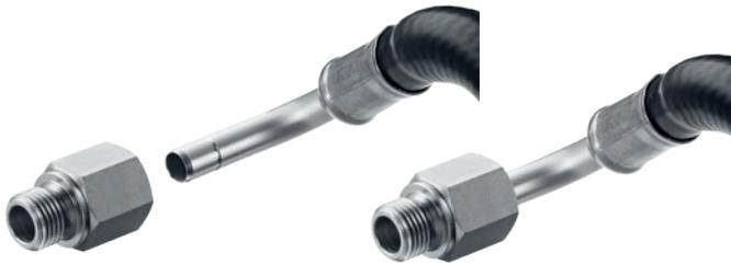
Zum Einkuppeln wird das Rohrende bzw. der Stecknippel mit der eingelassener Nut in den Quick Connector eingedrückt, bis er einrastet. Es wird empfohlen, dass ein korrektes Einstecken eines jeden Rohres mittels manuellem Zugtest bestätigt wird. Die Verriegelung des Rohres bzw. des Stecknippels im QC erfolgt durch die Nut im Rohr, das Nutsystem im QC und durch den Sprengring – eine besonders raumsparende Lösung, die kleinste QC-Durchmesser erlaubt.
