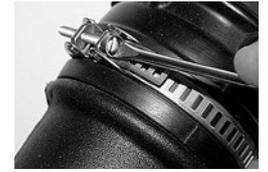
Klemmverbindung mit Schraubendreher oder Sechskantschlüssel spannen.
