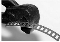
Bandlänge abschneiden. Um Verletzungen zu vermeiden, sollten scharfe Kanten mittels Feile entgratet und Ecken gephasst werden.
