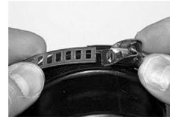
Band um das Abbindegut legen. Freies Bandende über Einhängehaken und unter der Schraube positionieren. Das Bandende kommt unter dem Schraubkörper zu liegen. Einhängehaken in engster Position einhängen.
