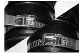
Band um das Abbindegut legen. Mit geringer Kraft freies Bandende hinunterdrücken, Spannhebel hin und her bewegen, bis Klemmverbindung gespannt ist. Spannhebel in geschlossene Position bringen. Die Arretierungssicke verhindert unbeabsichtigtes Öffnen.
