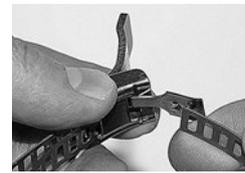
Spannhebel in geöffnete Position bringen und freies Bandende der Krümmung des Schlosses anpassen. Verformtes Bandende unter der Zunge hindurchführen, sodass das Bandende über dem Spannschlosskörper liegt.
